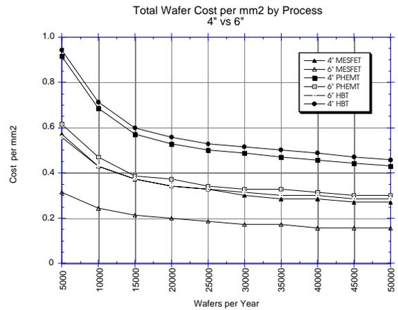
Fig. 7 - Total Cost per Wafer
