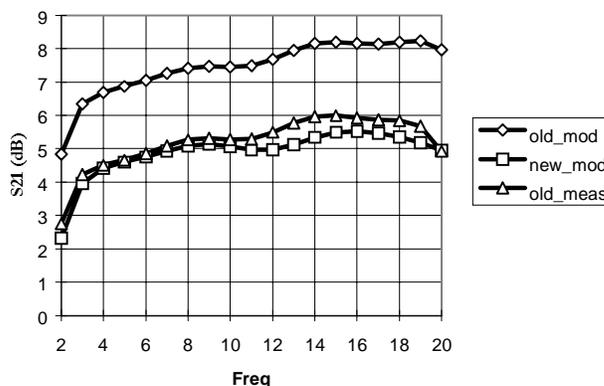
Figure 8: LNA Model Comparison, S21
