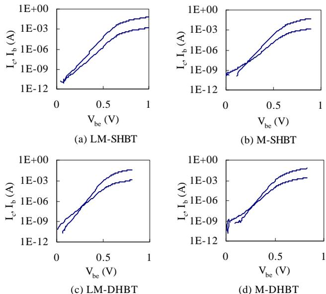
Figure 2. Gummel plots of (a) LM-SHBT, (b) M-SHBT, (c) LM-DHBT and (d) M-DHBT
