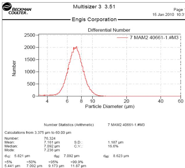
FIGURE 2 DIAMOND PARTICLE SIZE DISTRIBUTION
